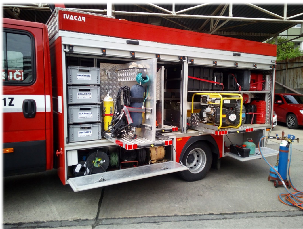
Obrázek 27: Vozidlo střelmistra, výbava.
