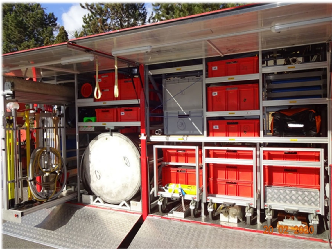
Obrázek 21: Levá strana – uložení nosítek a pojezdů (pravý horní roh) KCH
