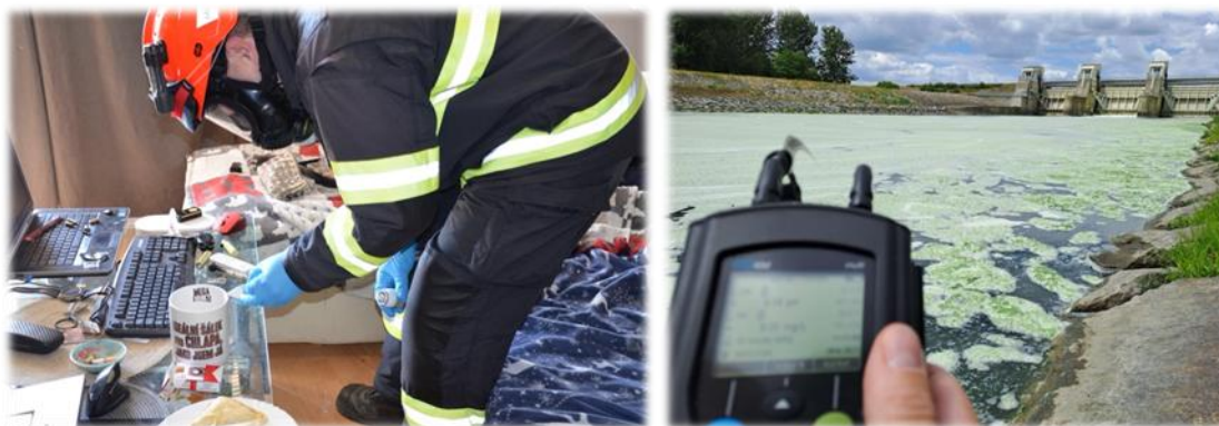
Obrázek 24: zjišťování přítomnosti OPL, monitoring fyzikálně-chemických parametrů vody
