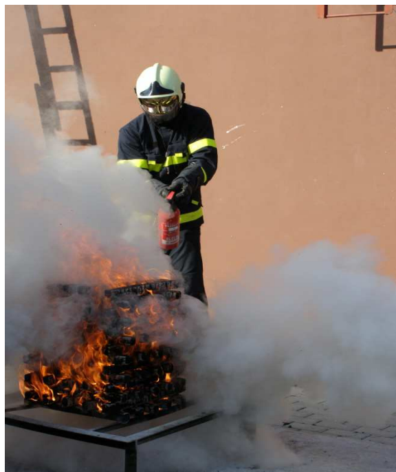
Hašení zkušebního objektu A práškem F 75 (DVÚ č. 6 VF20112015021)
