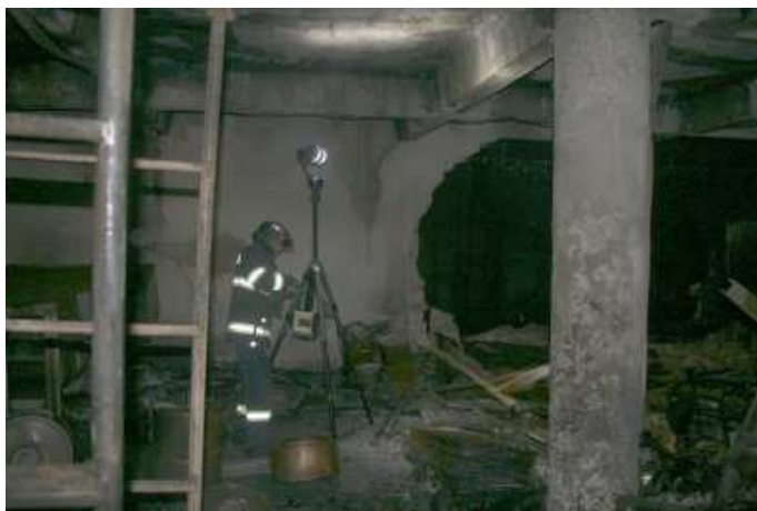
Instalace sferické kamery v prostoru požárem poškozeného bývalého průmyslového areálu Svit ve Zlíně
