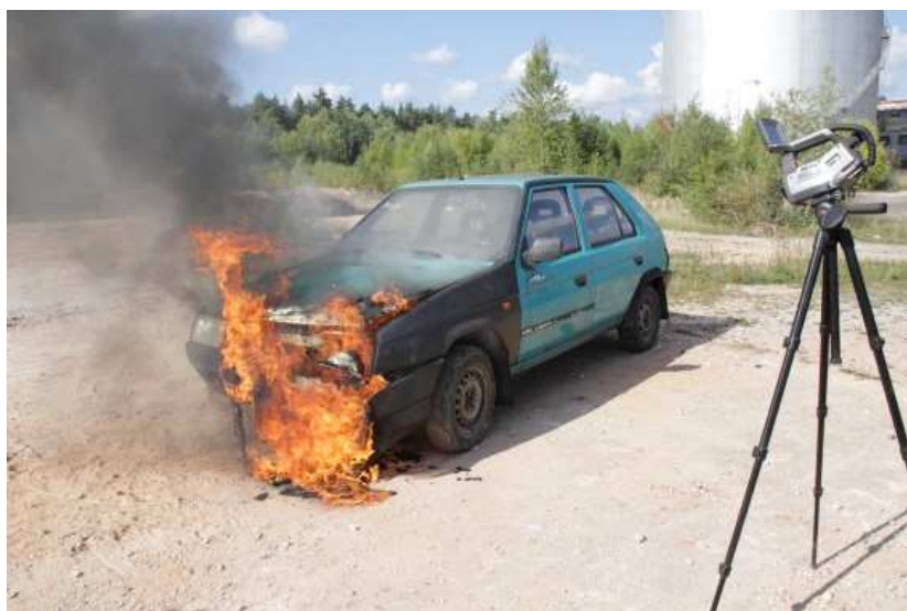
Zkoumání ohniskových příznaků u automobilů – pokusný požár osobního automobilu Škoda Favorit
