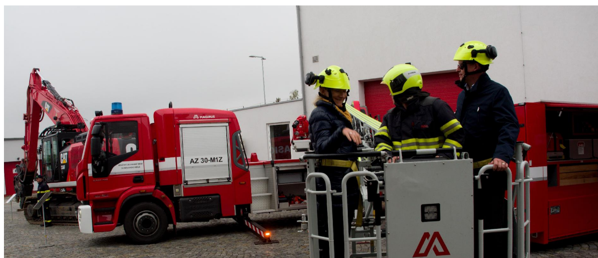
Obrázek 2 Kontejner technický pro nouzové zastřešení, automobilový žebřík AZ 30 Magirus a pásové rypadlo CATERPILLAR 336F
