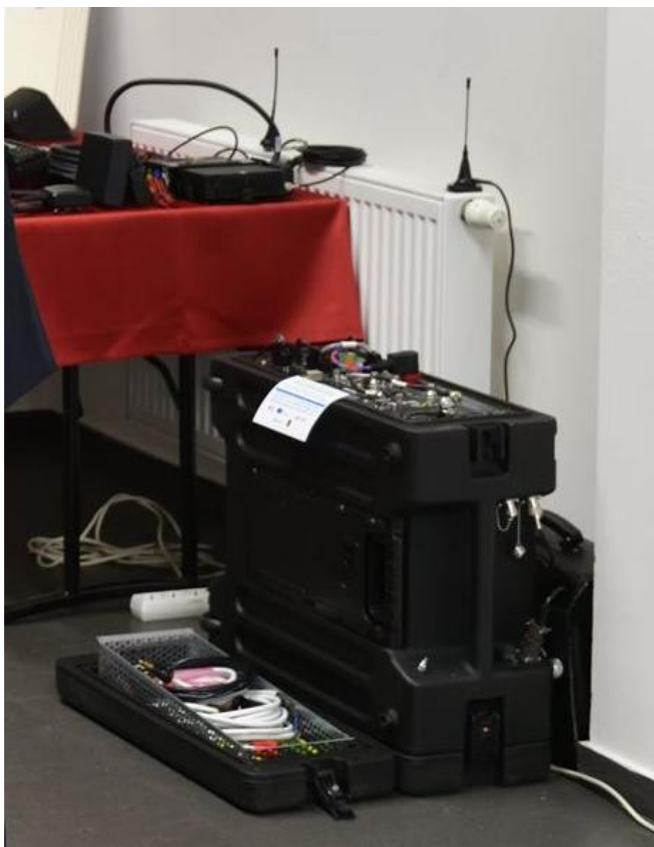
Obrázek 9 Nezávislý digitální opakovací, na stole vozidlový terminál (foto – zdroj: webové stránky Ministerstva pro místní rozvoj České republiky)
