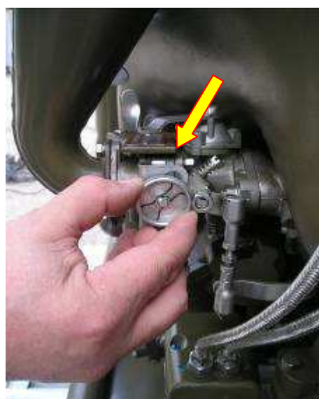
Obr. 65 Zajištění klapky karburátoru
