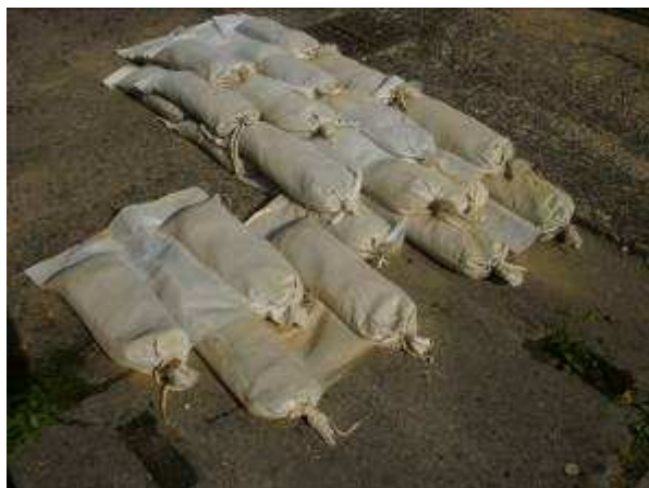
Obr. 14 Detail vazby dvoukomorových pytlů
