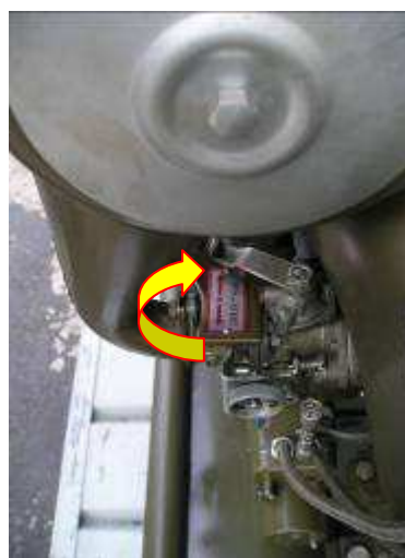
Obr. 68 Vrácení sytiče do polohy „Běh“
