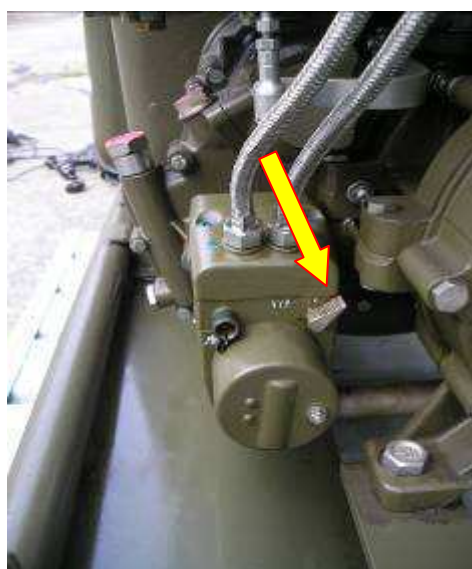
Obr. 64 Zapnutí magneta
