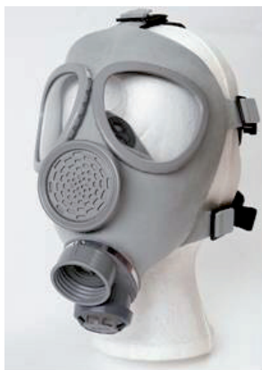
Obr. 3.8 Složení obličejové masky CM4 – lícnice (butylkaučuk, silikonový kaučuk, na vnitřní straně s těsnicí linií); zorník (plexisklo nebo tvrzené sklo); průzvučná (akustická) membrána kovová nebo plastová; vnitřní polomaska (zmenšuje mrtvý prostor v masce, u VDP se směrovými ventily); přípojka; ventilová komora – VDP a FDP nádechový a výdechový ventil – KDP ventily součástí přístroje; upínání – náhlavní kříž, popruh; nosný pás
