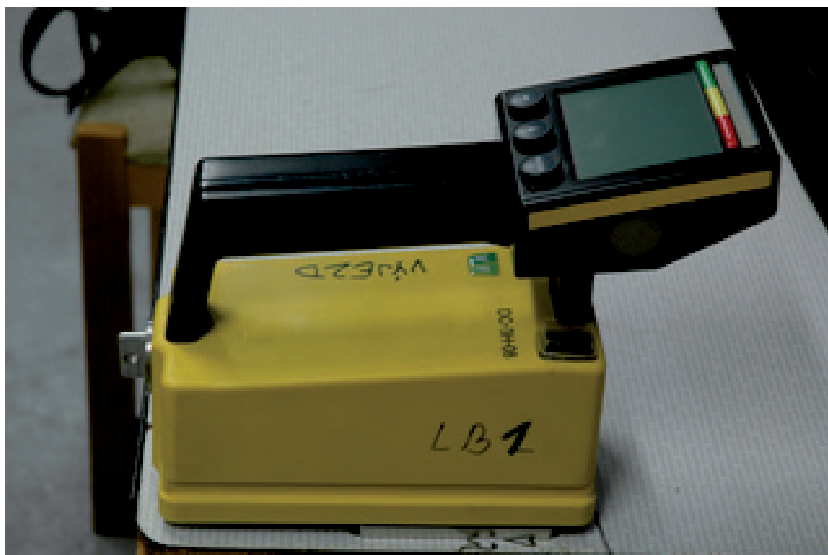
Umístění zásahového radiometru DC-3H-08 při provádění kontroly pozadí na pracovním stole
