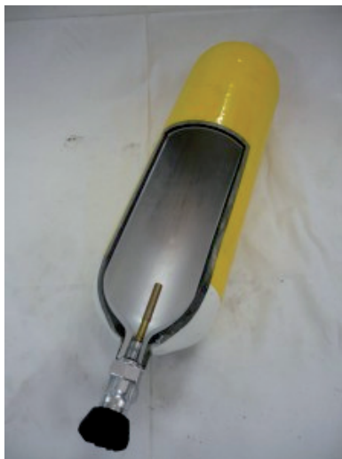
Obr. 4.1 Řez kompozitní tlakovou lahví
