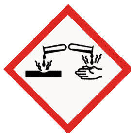
Korozivní a žíravé látky
