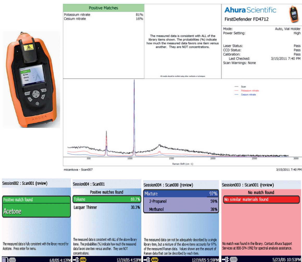
Obr. 7.21 Ramanův spektrometr a příklad výstupu z měření dusičnanu draselného (nahore), výstupy z měření (dole)
