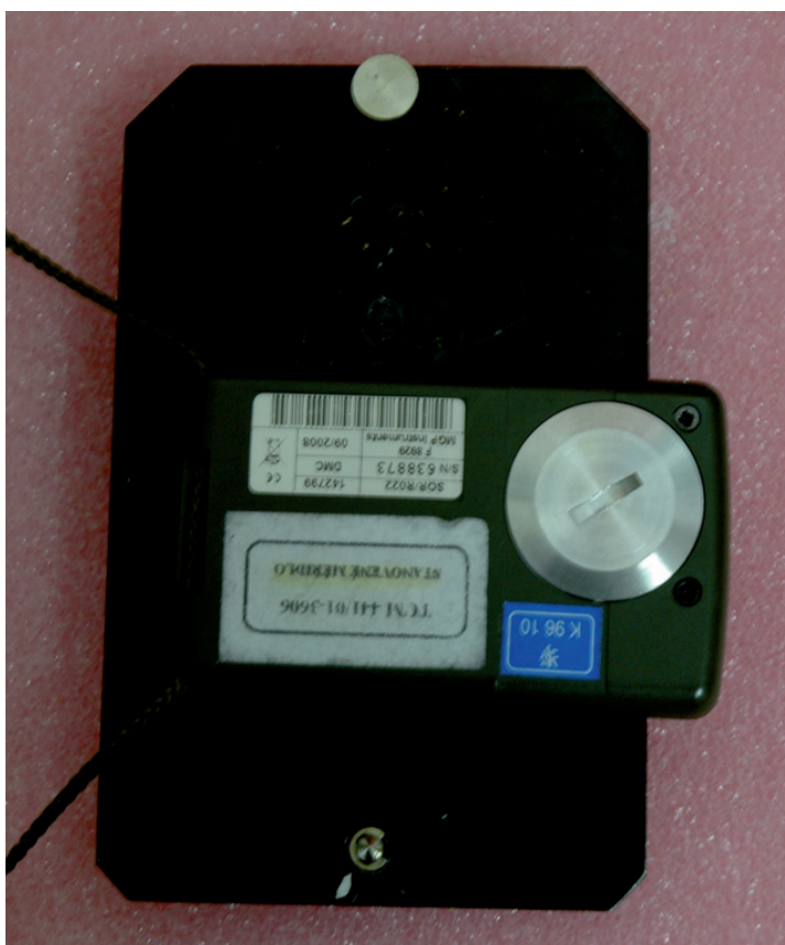
Umístění kontrolního etalonu od DC-3E-98 při kontrole osobního dozimetru SOR/R022 na etalon
