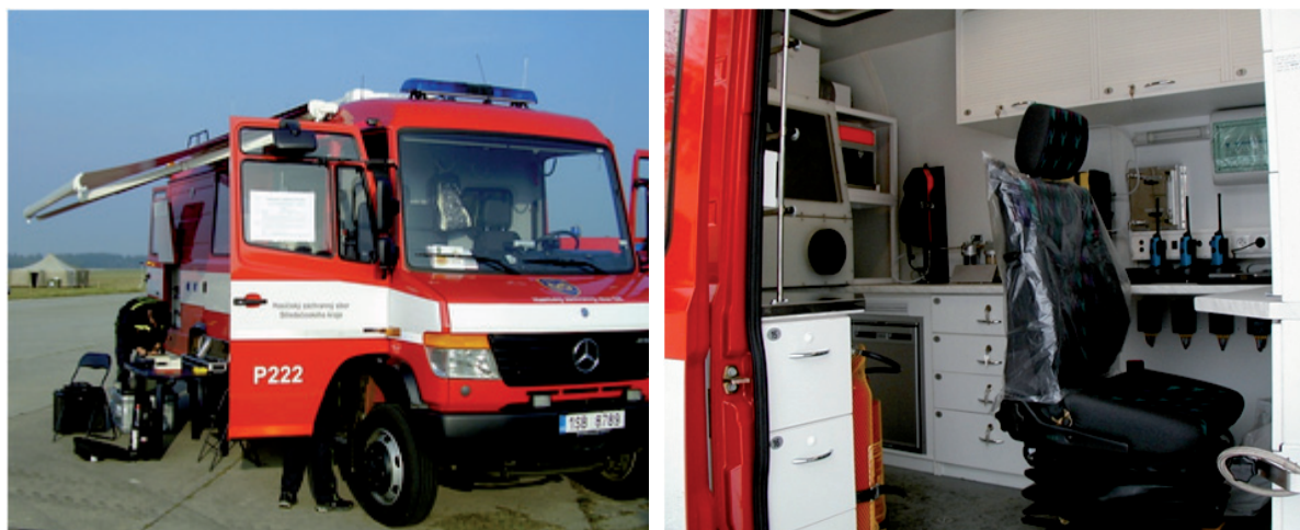
Obr. 9.2 Technický automobil chemický v provedení vozidla chemického a radačního průzkumu (TACHP)
