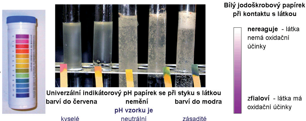
Obr. 7.3 Barevné chemické reakce lakmusového a jodoškrobového papírku vlivem změny pH nebo oxidačních vlastností látky
