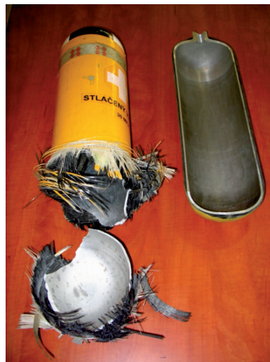
Obr. 4.2 Destrukce kompozitní tlakové lahve
