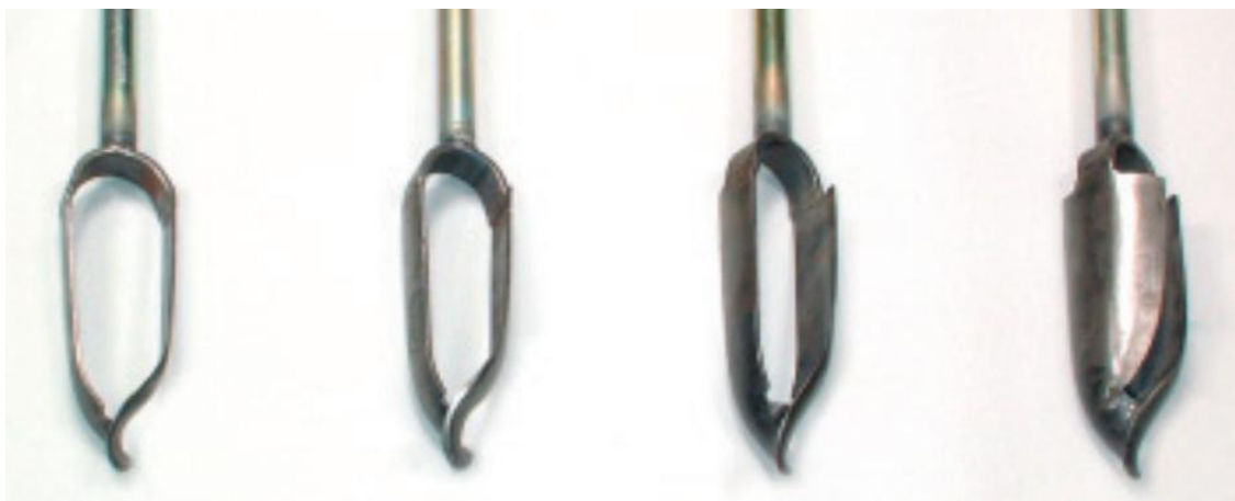
Obrázek 4 – Edelmanovy vrtáky: jíl, kombinovaný, písek a hrubý písek (foto: [16])
