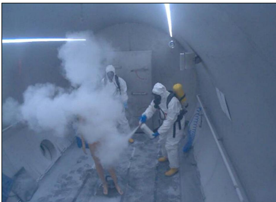
Obrázek 3: Nanášení reaktivního sorbentu Fast-Act na zkontaminovaného manekýna
