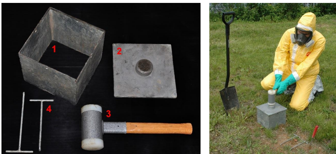
Obrázek 2 – Čtvercový půdní vzorkovač složený z masivní ocelové krychle (1), masivního ocelového víka (2), silikonové palice (3) a háků na vytažení (4). Druhý obrázek ukazuje použití tohoto vzorkovače.
