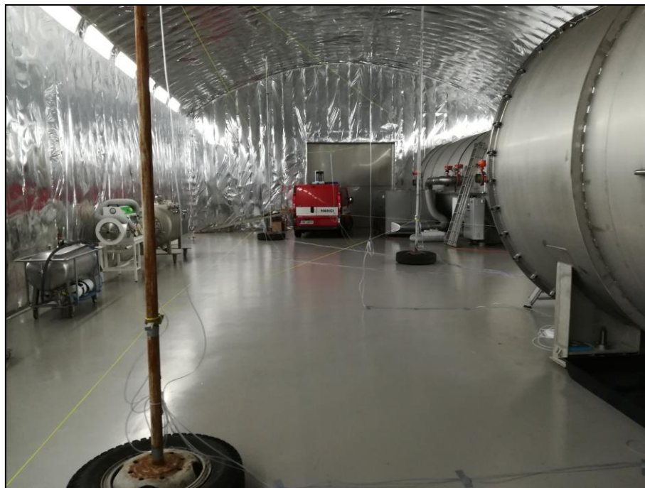
Obrázek 1: testovací rozložení v hale s rastrem odběrných míst propojených trubičkami. V pozadí Skenovací a zobrazovací systém SIGIS 2 pro dálkovou detekci analytů
