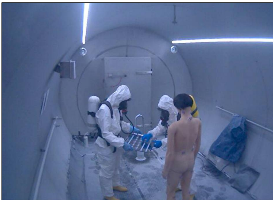
Obrázek 2: Připevňování kelímků s kontaminovanou umělou kůží na manekýna před dekontaminací
