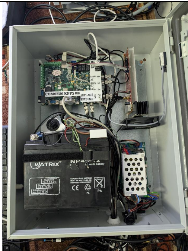
Dig. přijímač a vysílač DTRX52 s konc. zesilovačem
