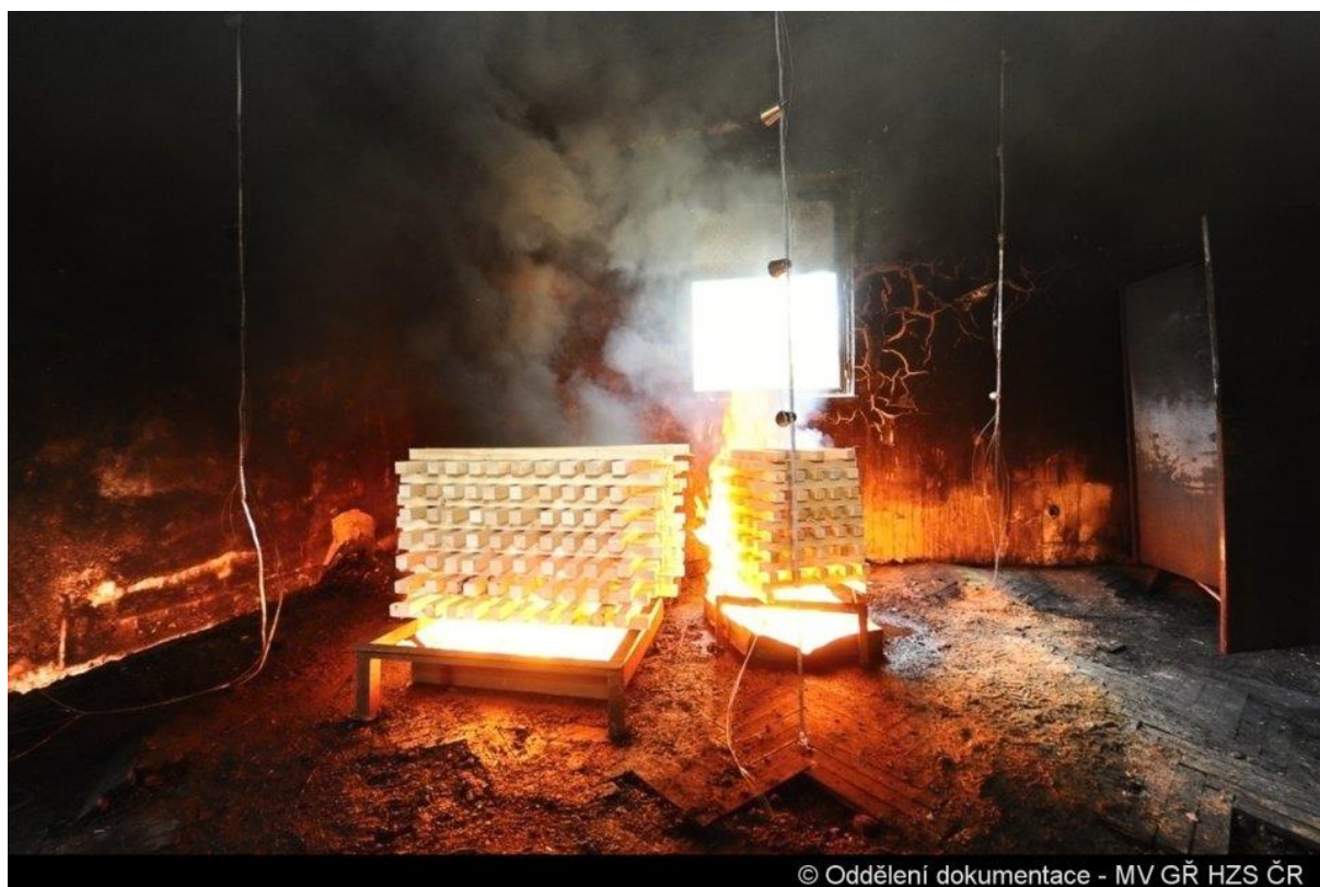
Obr. 3 Zkoušky účinnosti pulzního hašení v Chýňavě (spolupráce s HZS Středočeského kraje)
