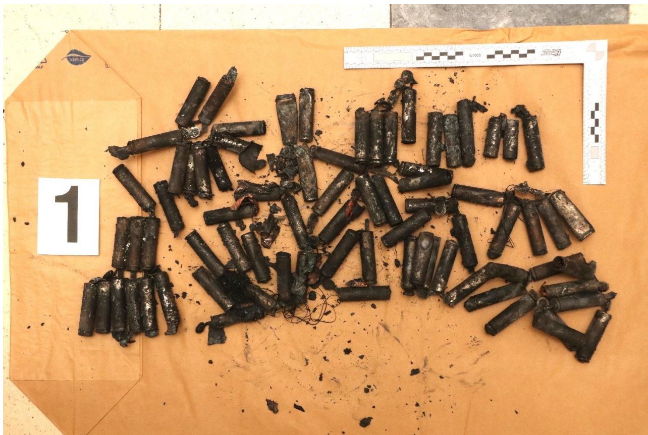
Poškozené články baterií nalezené na požářišti
