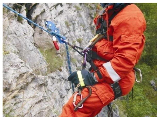
Jedná se o samoblokující slaňovací prostředek, u kterého není nutné při slaňování používat další zabezpečující prvek. Brzda STOP je šetrnější k lanům – v porovnání s osmou nebo karabinou HMS a poloviční lodní smyčkou. Nezatížené lano je možné protáhnout i v protisměru – výhodně např. při přestupu přes uzel.
