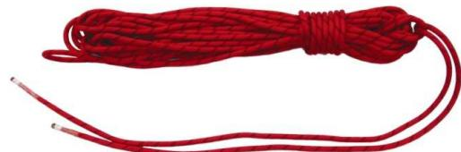
Další z možností balení lana je do klubíčka, které se využívá při používání lana na vrtulníku nebo shození lana do úzkého prostoru. *Obr. 133*. Je možné balit lano do speciálního vaku na lana, kde je lano postupně poskládáno a při odebírání z vaku nemůže dojít k zauzlování lana. *Obr. 134*. Před koncem lana ve vaku musí být na laně vytvořen uzel.
