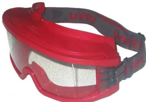
Pro ochranu zraku lezce lze využít ochranný štít na přilbě pro hasiče. Vhodnější je však používat samostatné ochranné brýle. Dnes se vyrábějí kvalitní ochranné brýle s dvojitým sklem, bránící pocení a zamezující vlétnutí nečistot ze strany brýlí. Tyto brýle jsou vybaveny kvalitním materiélem na průzoru s ochranným filtrem a zvýšenou odolností proti nárazu a teplotě. Příklad brýlí je uveden na obr. 80.
