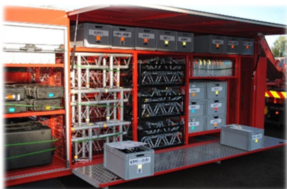
Obrázek 18, 19 – Kontejner s portálovými rámy a detektory záření gama ve správě SSHR.
