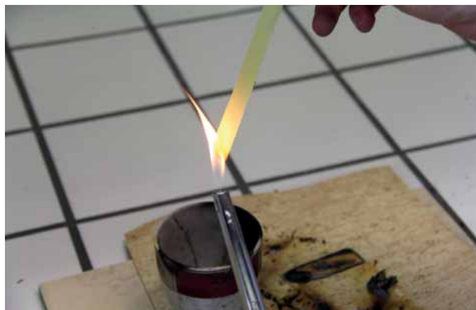
Obr. 2 Zapálení vzorku od spodní části
