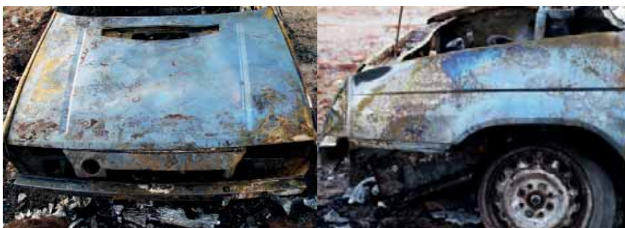
Obr. 4 vozidlo s kriminalistickým ohniskem v místě uchycení přední SPZ
