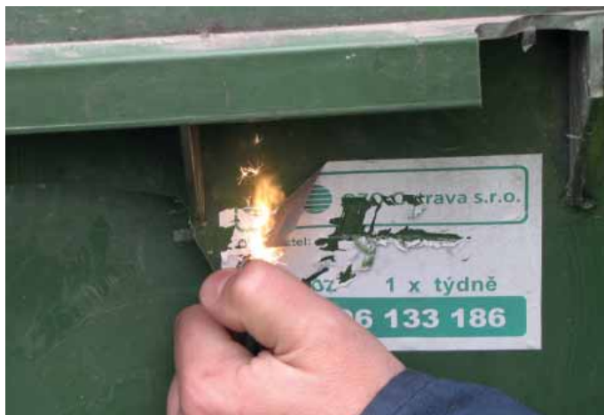
Pokus o zapálení kontejneru z vnější strany plamenem zapalovače. Po dobu působení plamene zapalovače (20 s) nedošlo k rozhoření kontejneru.
