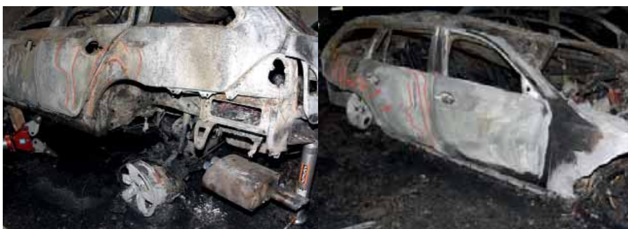
Obr. 5 Osobní automobil BMW destruovaný požárem v podzemních garážích
