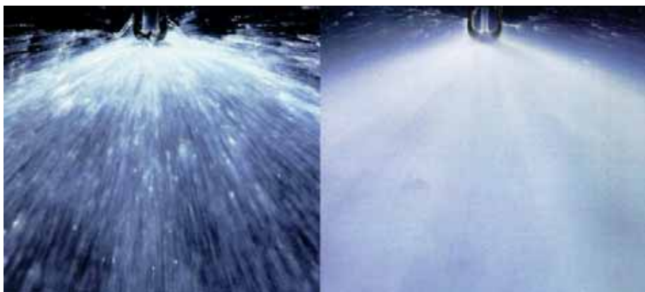
Rozdíl mezi sprchovým proudem a vysokotlakou vodní mlhou
