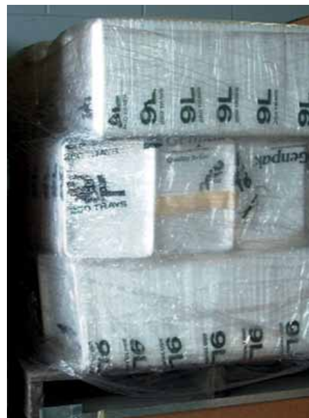
Požární zatížení pro skupinu „Plasty A“ – napěněné plasty (polystyrénové tácky) přímo vystavené požáru
