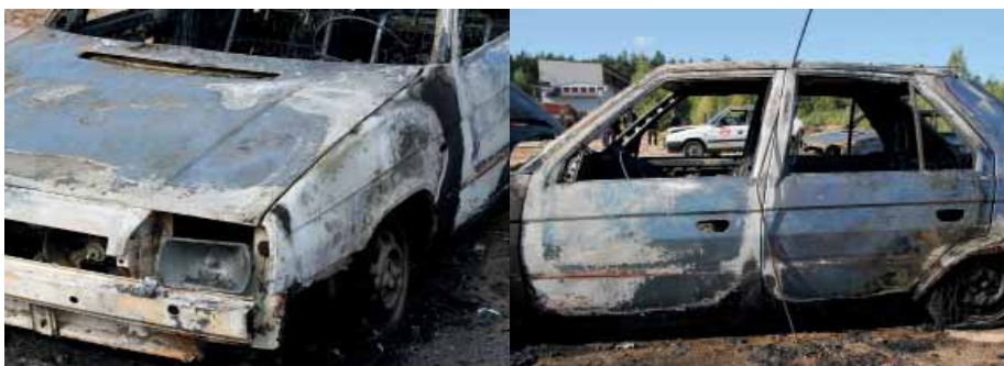
Obr. 3 Vozidlo s kriminalistickým ohniskem v prostoru levého předního kola
