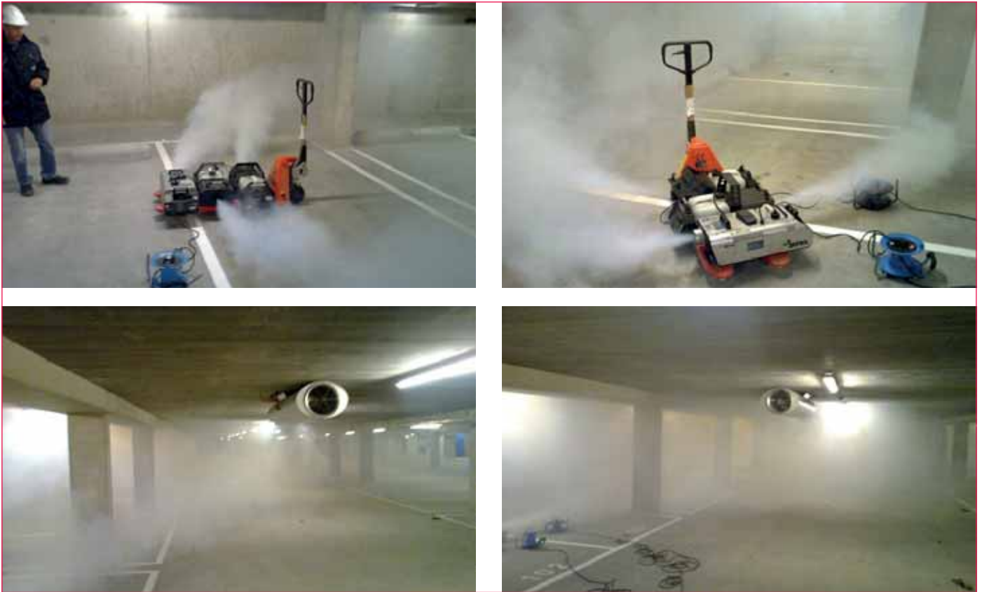
Obr. 6 Ukázka realizace netoxické kouřové zkoušky [12]
