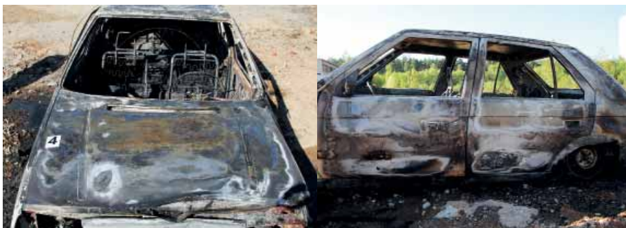
Obr. 2 Vozidlo s kriminalistickým ohniskem v prostoru pro cestující
