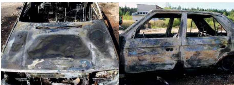
Obr. 1 Vozidlo s kriminalistickým ohniskem v motorovém prostoru
