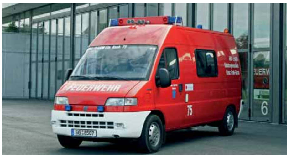
Obrázek 4 Speciální vozidlo pro chemický průzkum (ABC-Erkundungskraftwagen) [10]
