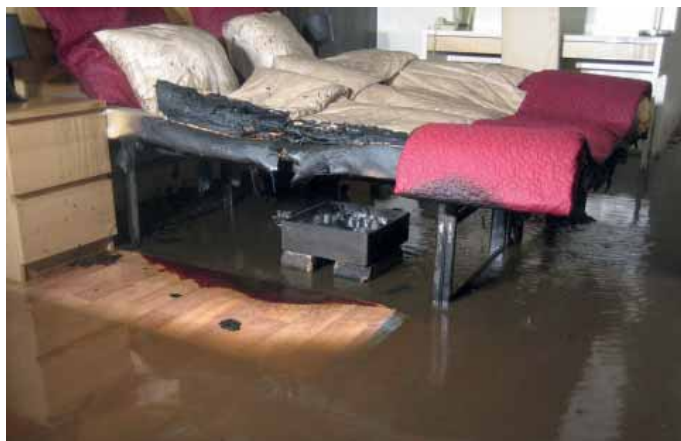
Demonstrační zkouška hasení hotelového pokoje vysokotlakou mlhou (vlevo) a sprinklery (vpravo)
