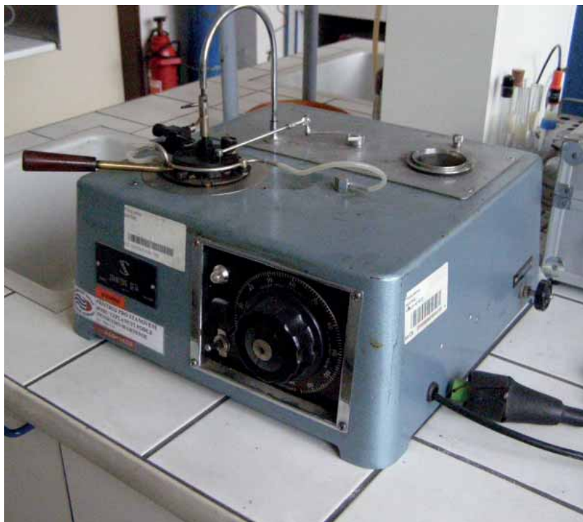
Obr. 2 Zkušební zařízení pro stanovení bodu vzplanutí v uzavřeném kelímku podle Penskyho-Martense
