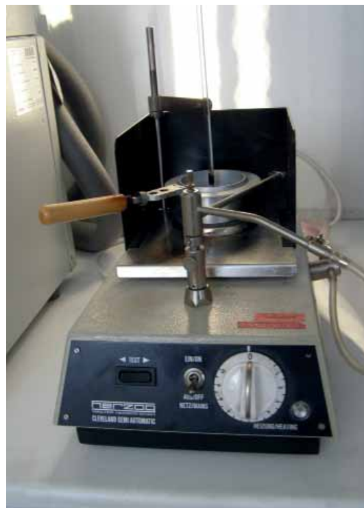
Obr. 3 Zkušební zařízení pro stanovení bodu vzplanutí a bodu hoření v otevřeném kelímku podle Clevelanda
