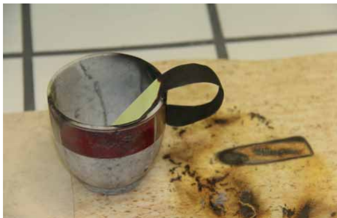
Obr. 10 Zkroucení vzorku na vnější stěně
