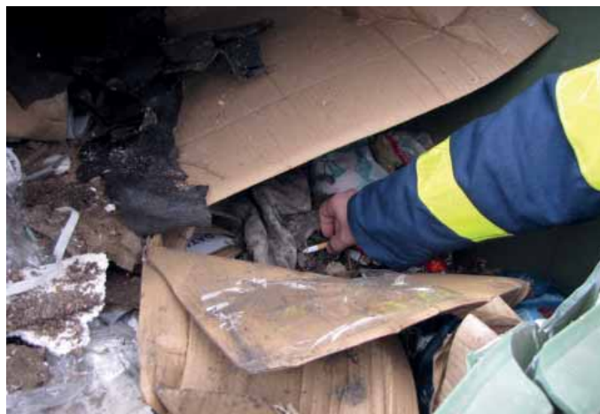
Pokus o zapálení odpadu uvnitř kontejneru žhavým nedopalkem cigarety. Po 10 minutách nedošlo ke vznícení žádného odpadu uvnitř kontejneru. Vzhledem k vlhkosti odpadu se tímto způsobem nepodařilo odpady zapálit.
