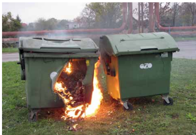
V této fázi pokusu došlo k poškození kontejneru natolik, že byla narušena jeho stabilita. Teplota plamene byla 300 °C. Levý kontejner byl zatím zcela nepoškozen.
