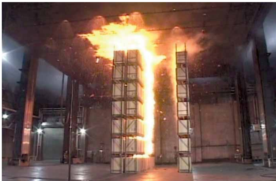
Příklad rozvoje požáru při ohňové zkoušce vysokoregálového skladu
