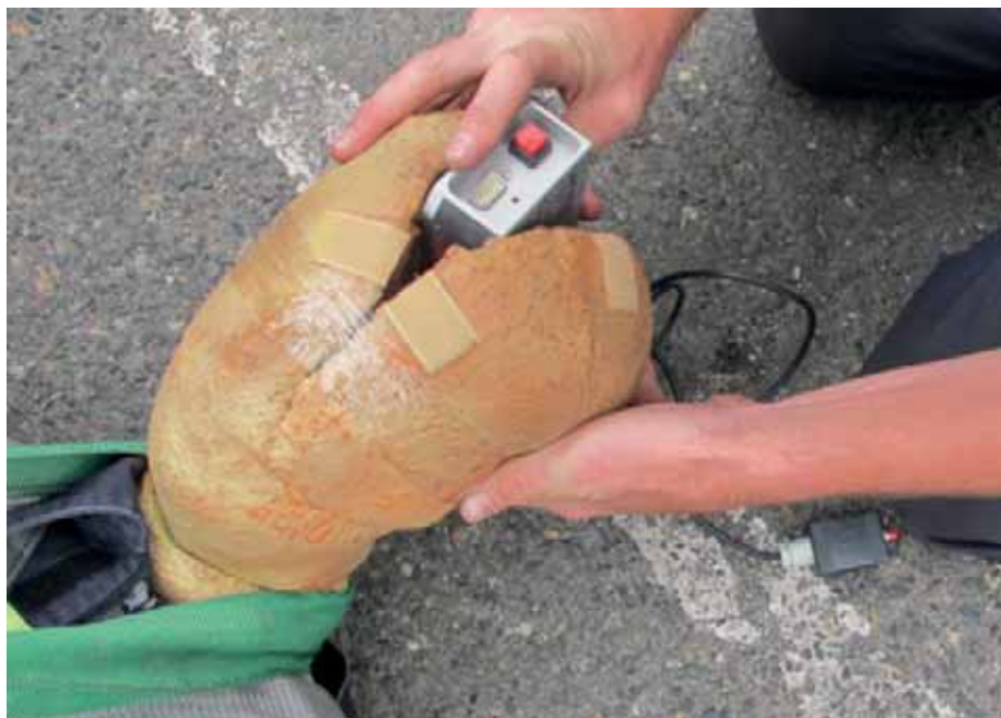
Obr. 4 Čidlo zpomalení umístěné v hlavě figuríny
