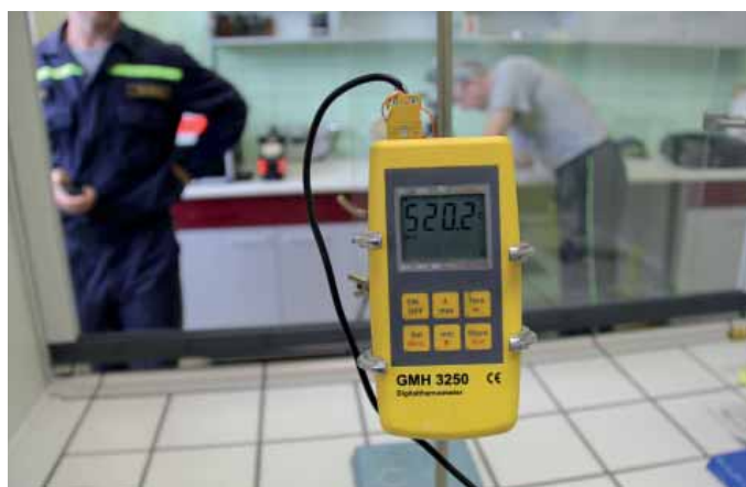
Obr. 4 Naměřená maximální teplota plamene
