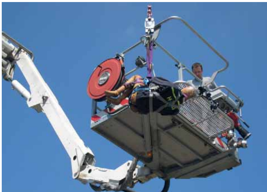
Obr. 5 Zkušební figurína upevněná na koši AP ve výšce 16 m
