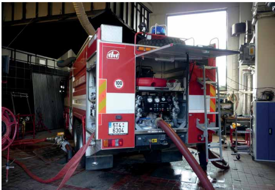
Zkouška trvalého chodu
