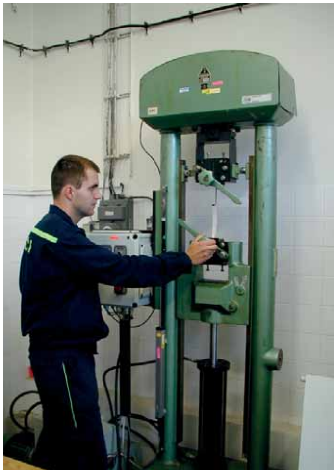
Obrázek 7 Stanovení soudržnosti vrstev tlakové požární hadice
