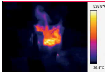
Teploty zaznamenané termokamerou - hořící koš - okamžik vznícení
