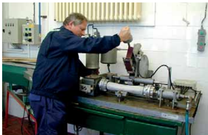
Obrázek 6 Zkouška opotřebení oděrem tlakové požární hadice
