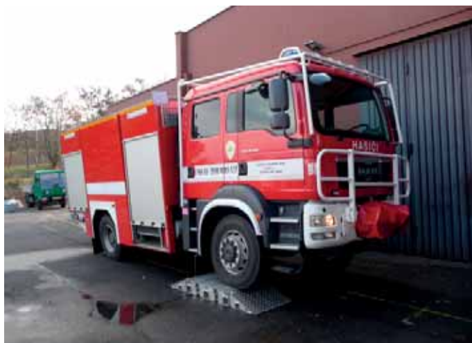
Obrázek 1 Zkouška mezinápravové průchodnosti
