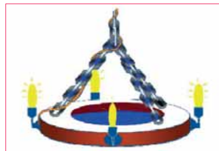
Obr. 4 Svedení průsvitných nasávacích kapilár podél lustru. Zdroj: [6]
