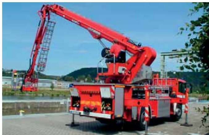
Obrázek 4 Zátěžová a funkční zkouška automobilové plošiny
