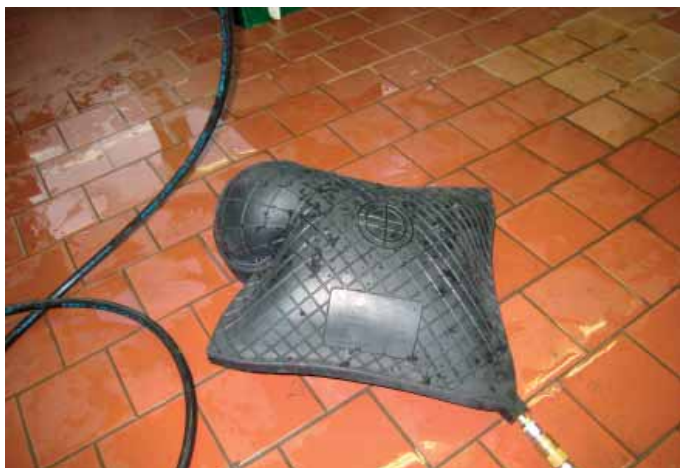
Obrázek 9 Tlaková zkouška zvedacího vaku
