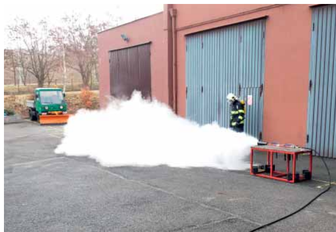
Obrázek 2 Funkční zkouška užití hasičího média CO 2 u kombinovaného hasičího automobilu
