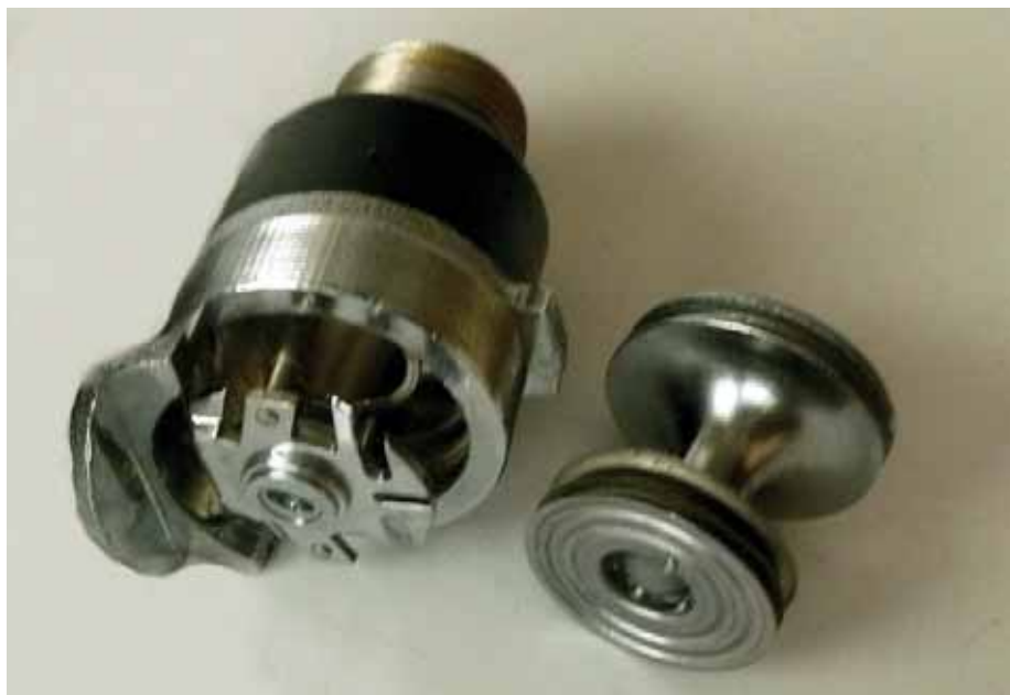
Obrázek 3 Tavná pojistka sprinkleru AQURIUS
