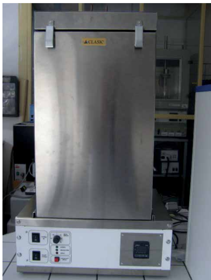
Obrázek 1 Zkušební zařízení podle ČSN EN 15794 [1]
