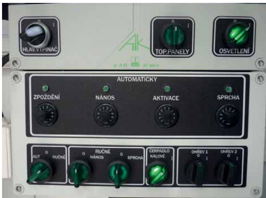
Technologická část – nastavení automatického a ručního provozu
