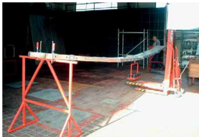
Obrázek 8 Zkouška průhybu přenosného požárního žebříku
