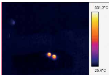
Teploty zaznamenané termokamerou - zapálení cigarety
