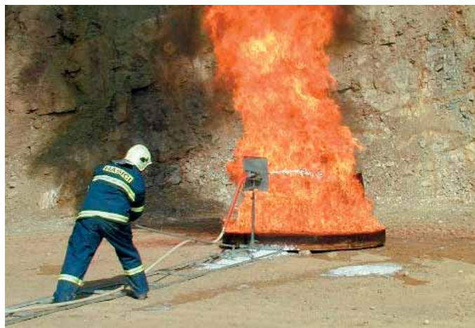
Obrázek 10 Zkouška hasební schopnosti
