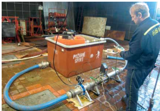
Obrázek 5 Zkouška průtoku plovoucího čerpadla
