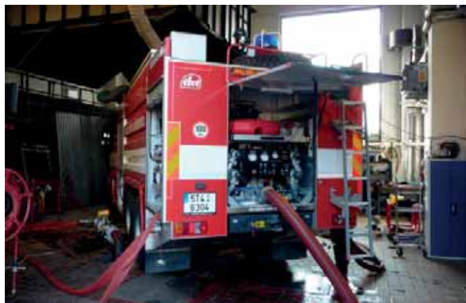
Obrázek 3 Provozní zkouška čerpadla cisternové automobilové stříkačky
