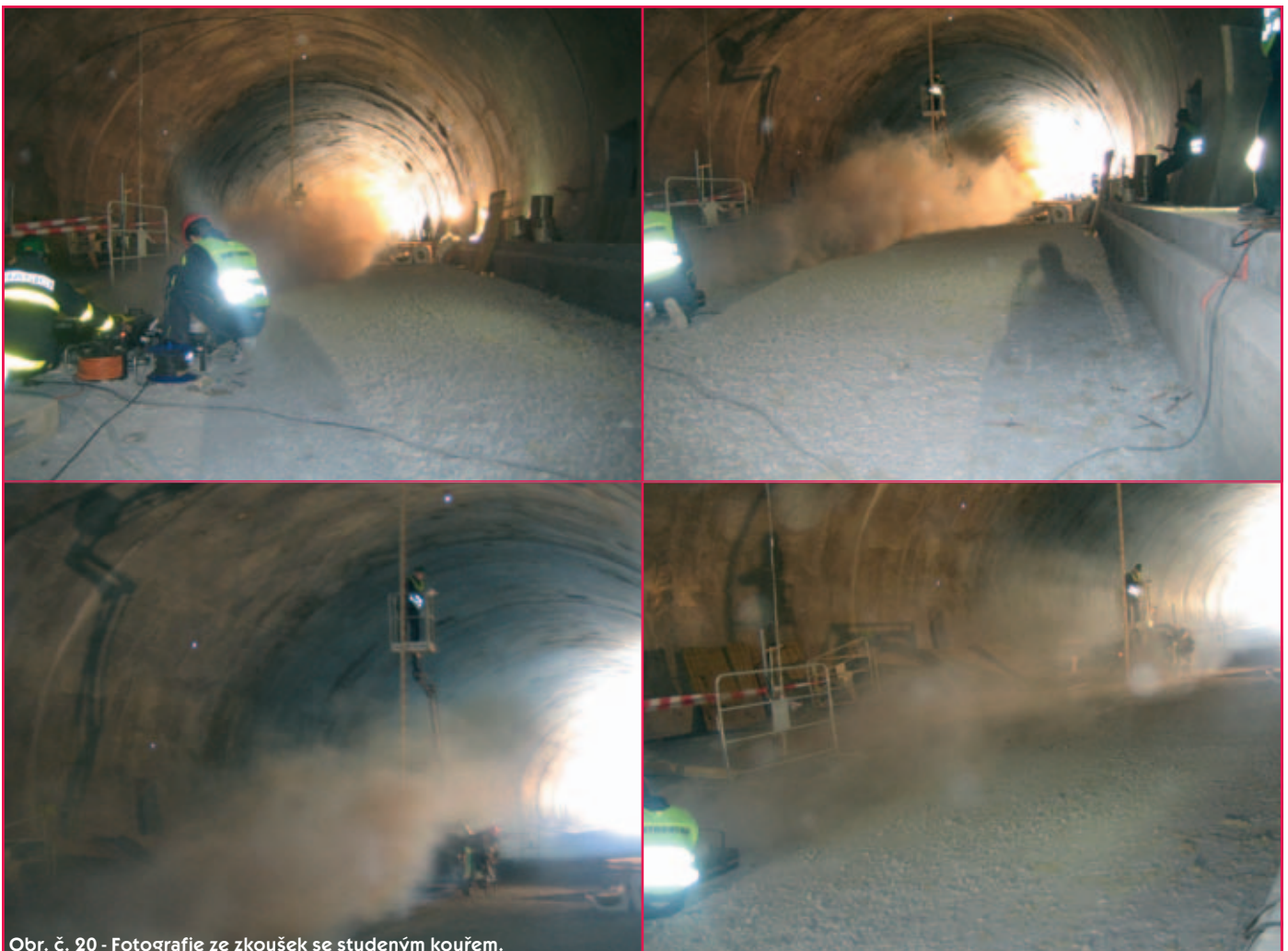
Obr. č. 20 - Fotografie ze zkoušek se studeným kouřem.
