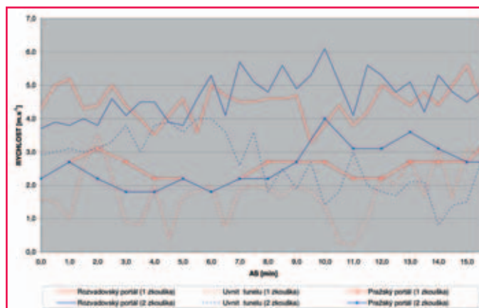
Obr. č. 21 - Rychlosti proudění plynů v průběhu experimentu při první a druhé zkoušce.
