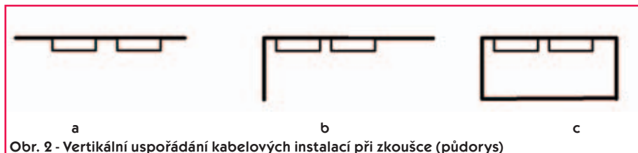
Obr. 2 - Vertikální uspořádání kabelových instalací při zkoušce (půdorys)
