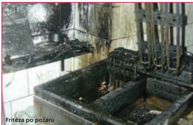
Dílcí části fritézy po požáru
