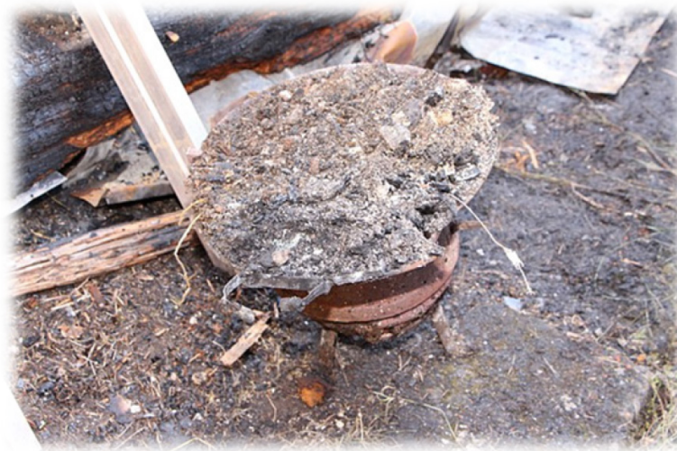
Obrázek 18 - přenosný gril, vyneseny z 1.NP, z kriminalistického ohniska požáru
