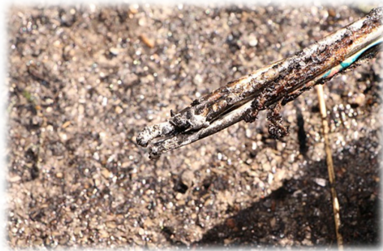
Obrázek 23 - přehořelý el. vodič vzdušné přípojky z el. sloupu NN (na konci s nátavkou)
