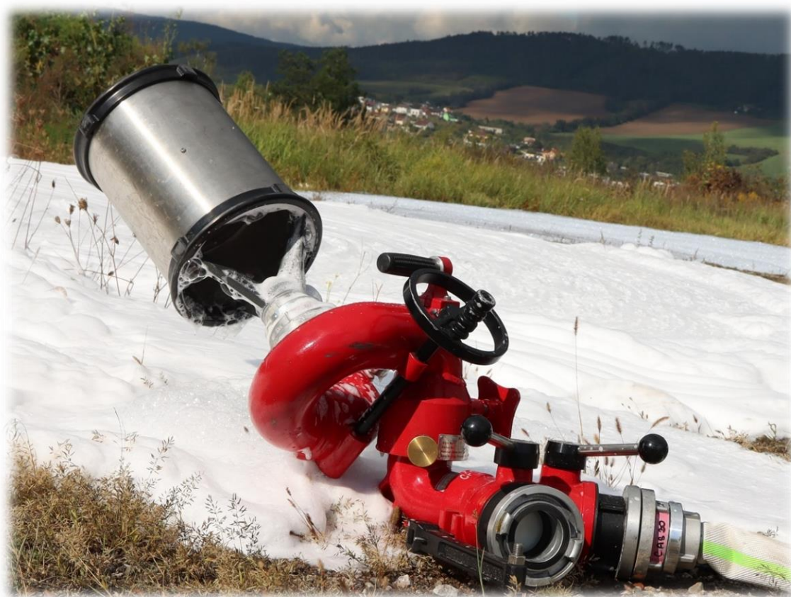
Obrázek 4: Zkoušky přiměšování pseudoplastických, bezfluorových pěnidel
