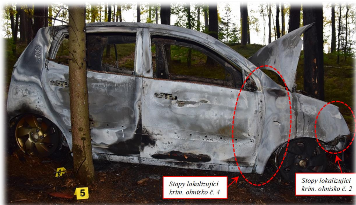
Obrázek 7: Pohled na stopy postupného šíření požáru na pravé straně karoserie vozidla
