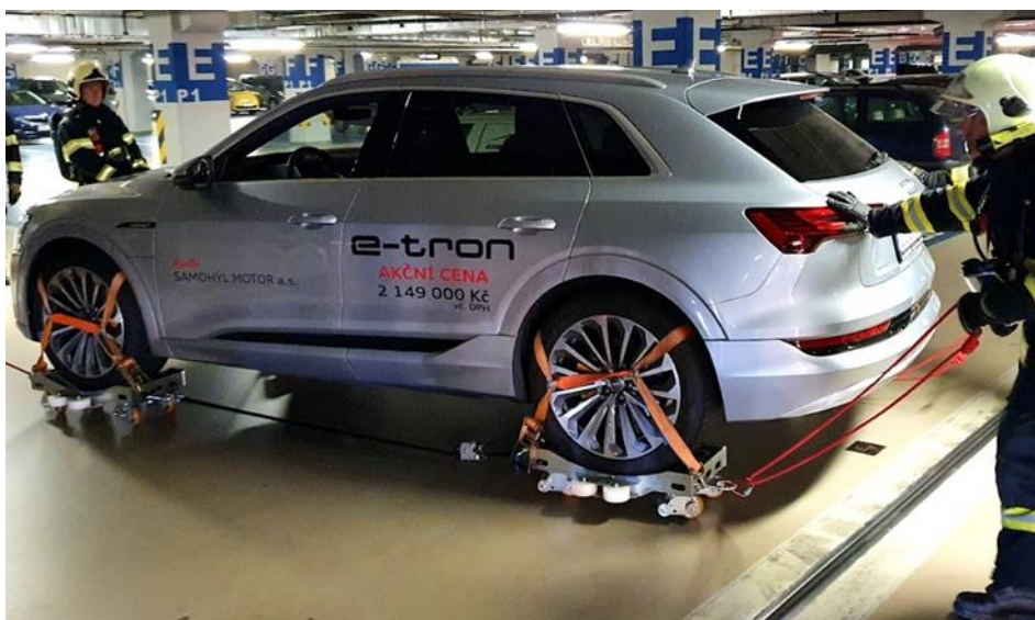
Obrázek 34 – Vozidlo připravené k manipulaci pomocí pojízdných vozíků
