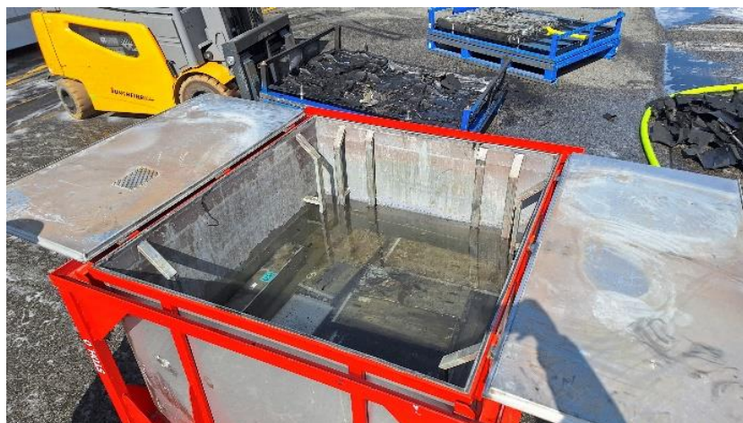
Obrázek 30 – Zaplavené nestabilní moduly po požáru
