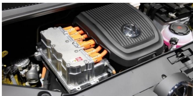
Obrázek 16 – „HV“ rozvody viditelné v motorovém prostoru
