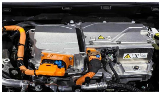
Obrázek 16 – „HV“ rozvody viditelné v motorovém prostoru
