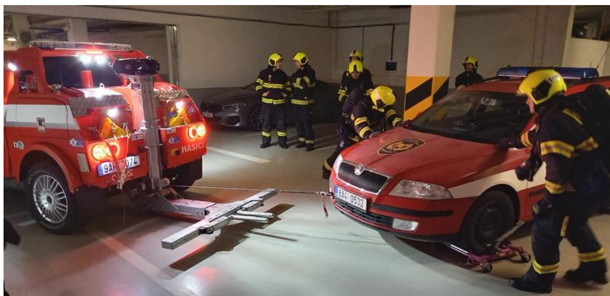
Obrázek 38 – Vytážení vozidla pomocí navijáku
