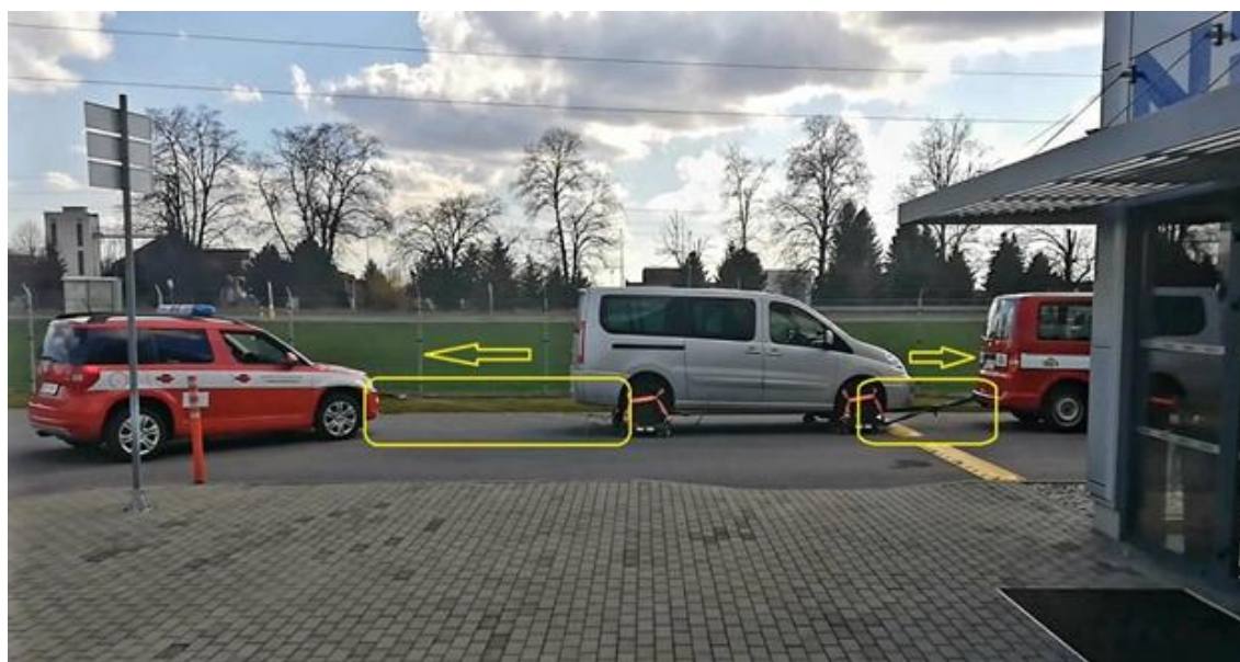
Obrázek 35 – Manipulace v soupravě vlečného, vlečeného a brzdného vozidla
