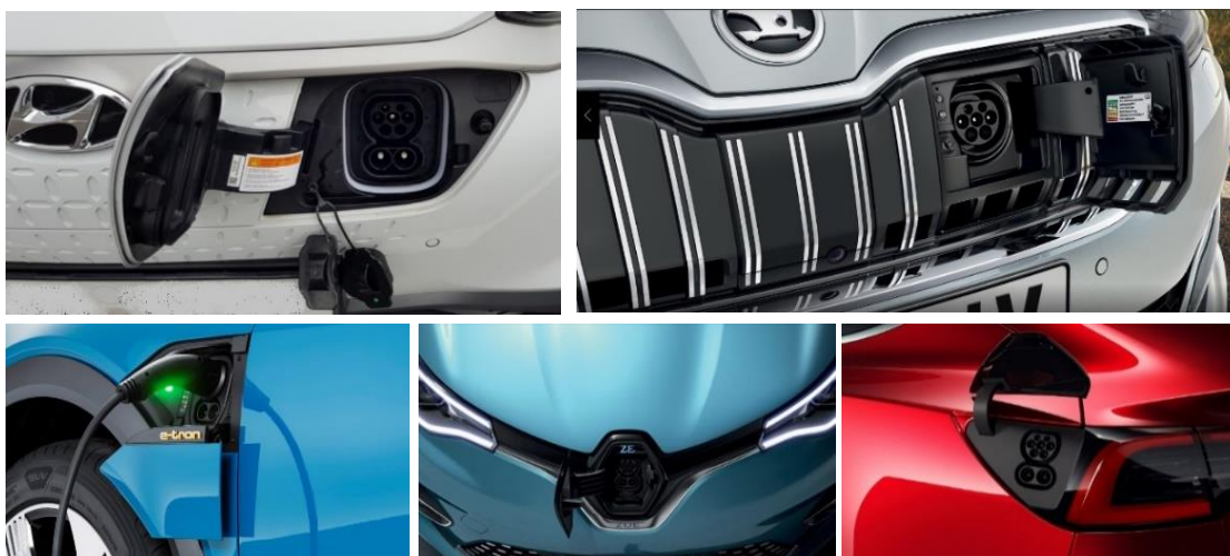
Obrázek 15 – Příklady umístění konektorů na vozidlech
