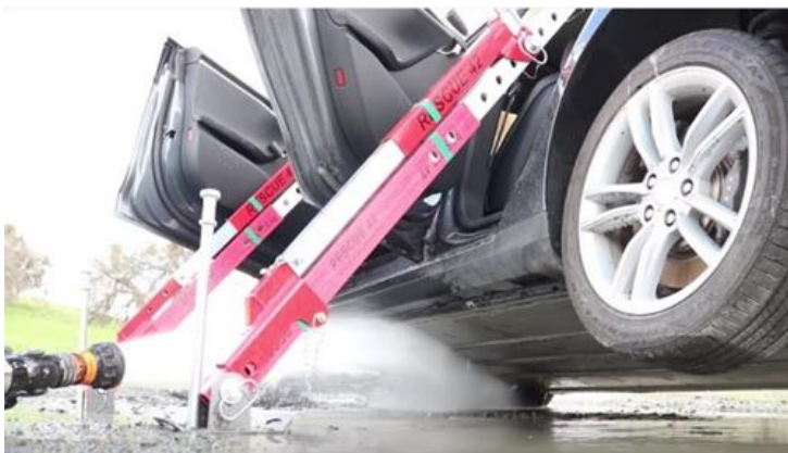
Obrázek 25 – Polohování vozidla při chlazení baterií
