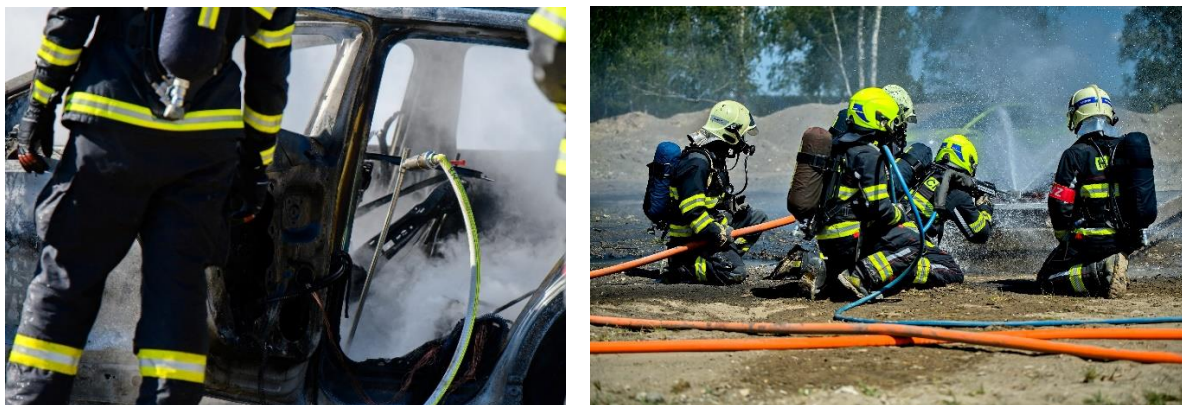
Obrázek 26 – Zařízení pro vstup do baterie (vlevo hasící hřeb, vpravo zařízení pro hašení a řezání vodním paprskem)
