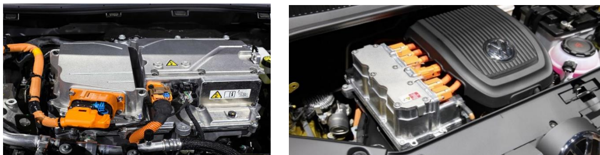
Obrázek 16 – „HV“ rozvody viditelné v motorovém prostoru
