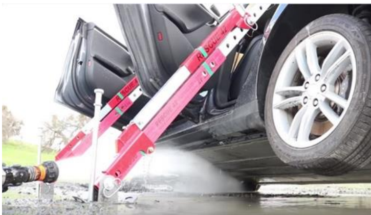
Obrázek 25 – Polohování vozidla při chlazení baterií
