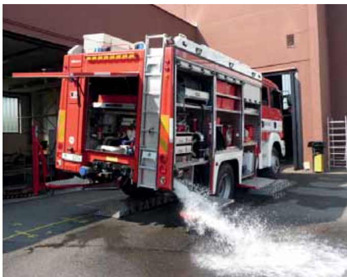
Ověření funkčnosti čerpadla při zkoušce mezinápravové průchodnosti
