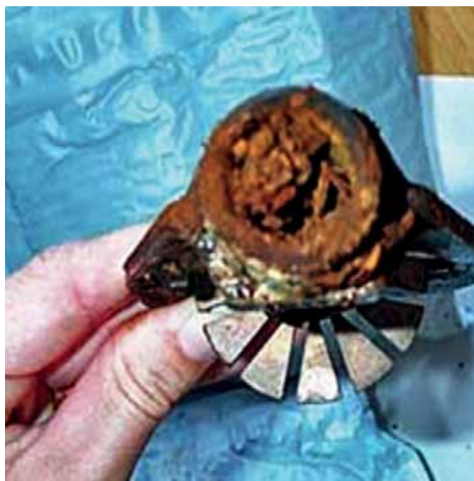
Zanesený výstřikový otvor sprinkleru
