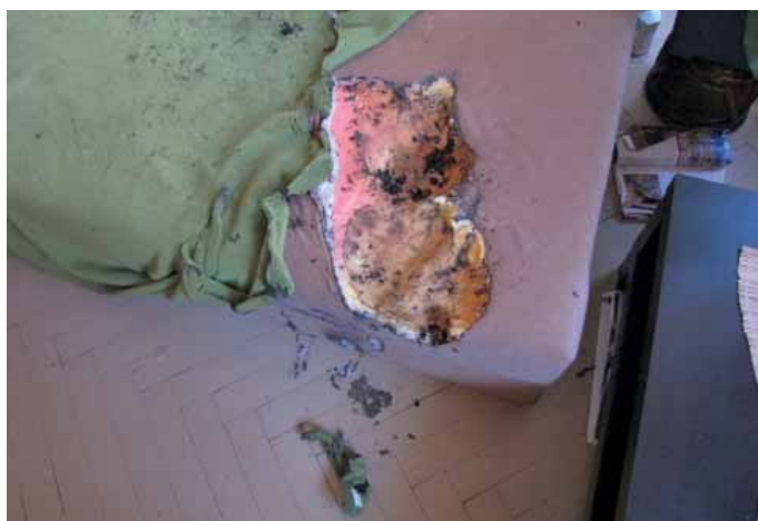
Ohnisko vzniku požáru
