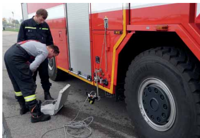
Instalace optického systému Correvit Corrsys na zkoušené vozidlo
