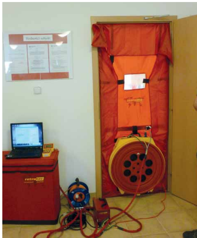
Zařízení pro zkoušku těsnosti chráněného úseku (Door Fan Test)
