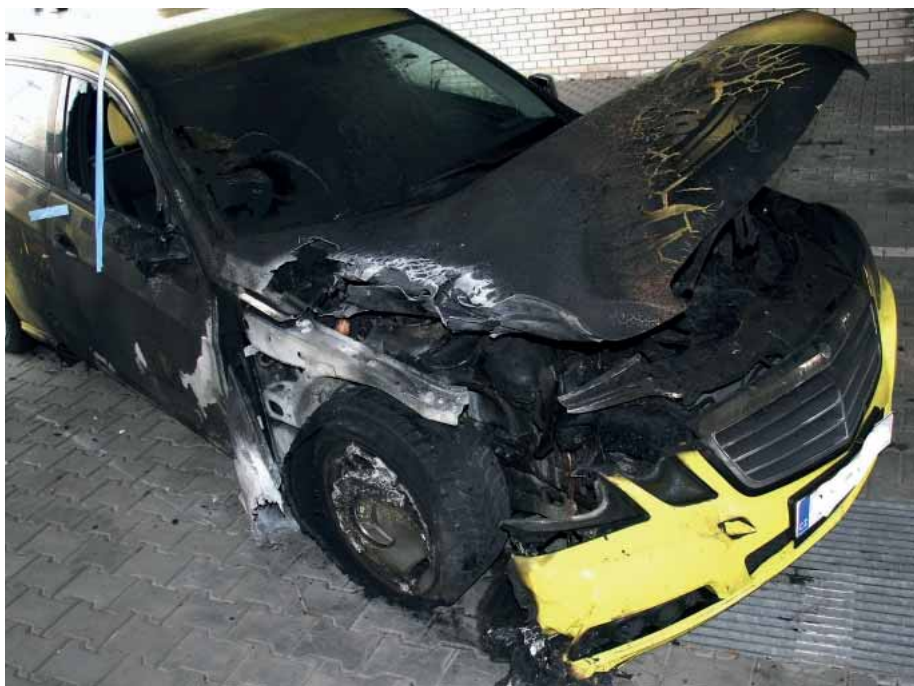
Obr. 1 Stav vozidla po požáru s naznačenou pozicí instalovaného DPF
