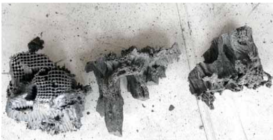
Obr. 3 Tepelně destruované zbytky voštinového filtru DPF
