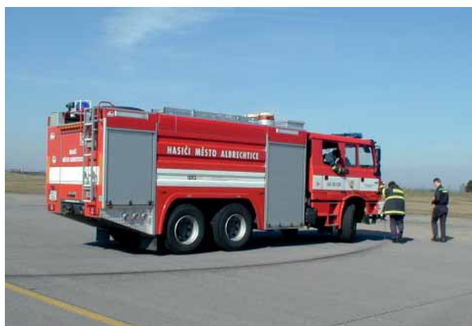
Měření obrysového průměru zatáčení
