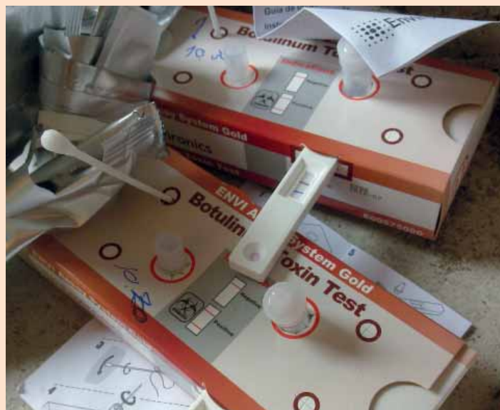
Přenosná identifikace s pomocí imunochromatografie – obsluha je možná i v ochranném oděvu
