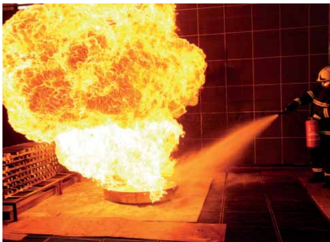
Zkouška účinnosti hašení pěnovým ručním hasicím přístrojem
