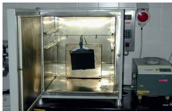
Zkušební komora pro zkoušení odolnosti zásahových oděvů proti teplu
