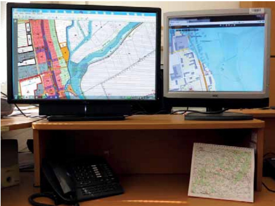
Obr. 4 Detailní porovnávání vyznačení zóny ohrožení povodní Q 1000 v konkrétní ÚPD s webovou mapovou vrstvou Q 1000
