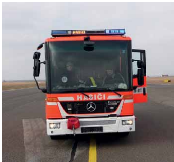
Vychýlení vozidla z přímého směru jízdy směrem doleva proti žluté čáře při zkoušce dynamické stability při brzdění
