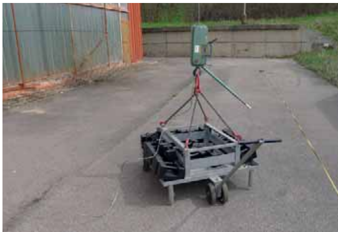
Zařízení pro ověřování tuhosti žebříkové sady zavěšené na koši
