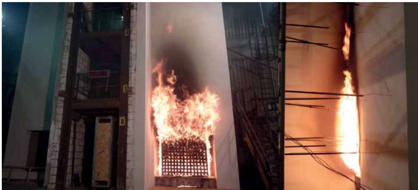
Obrázek 2 Kromě namáhání ostění bylo při větších požárních zkouškách ETICS pozorováno porušení krycích vrstev ve výšce přibližně 1 m nad nadpražím. Vlevo BS 8414-1 [2]. Vpravo Koncept DIN 4102-20 [3].
