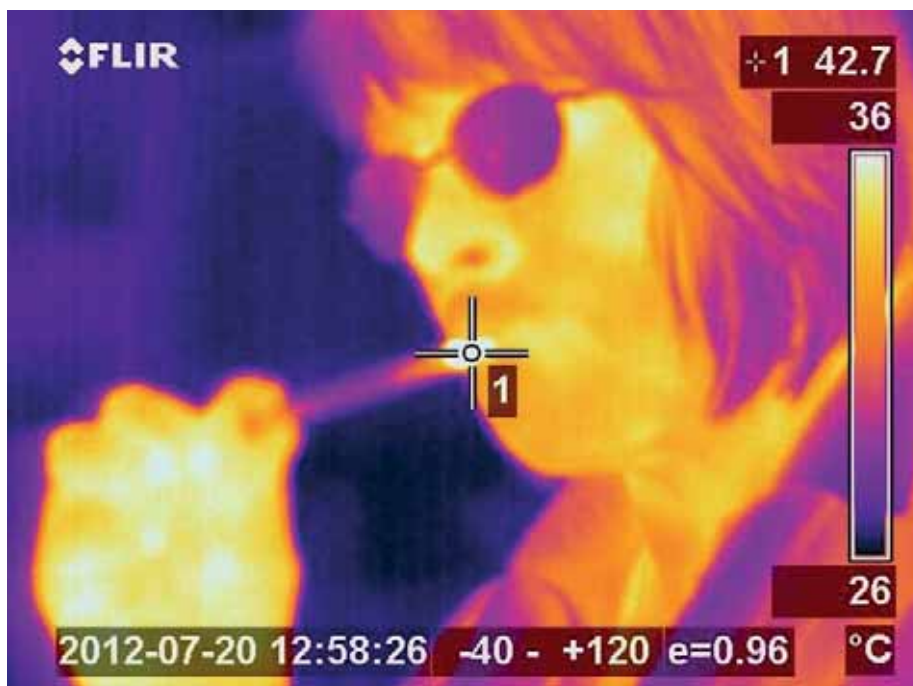
Obr. 2 Termovizní snímek znázorňující rozložení teplot při aktivním kouření e-cigarety
