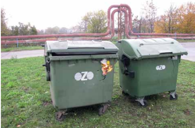
Zapálení odpadu v kontejneru bylo úspěšně provedeno plamenem zapalovače, kdy byl zapálen v levém kontejneru vyčnívající kus polystyrénové desky. V tento okamžik bylo započato měření času.
