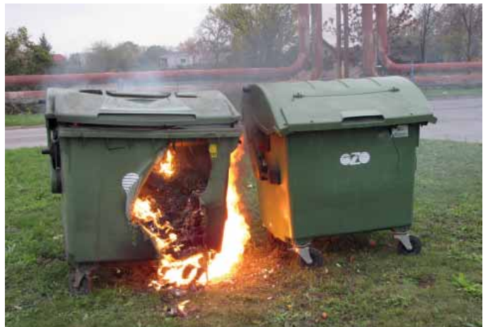
V této fázi pokusu došlo k poškození kontejneru natolik, že byla narušena jeho stabilita. Teplota plamene byla 300 °C. Levý kontejner byl zatím zcela nepoškozen.
