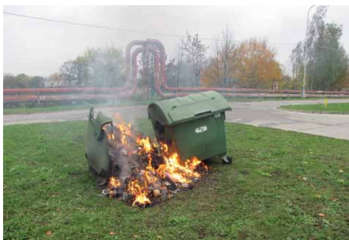
Šíření požáru na pravý kontejner způsobilo jeho destabilizaci a postupné zapalování odpadů uvnitř tohoto kontejneru.
