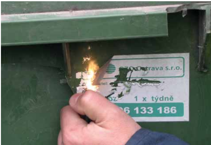
Pokus o zapálení kontejneru z vnější strany plamenem zapalovače. Po dobu působení plamene zapalovače (20 s) nedošlo k rozhoření kontejneru.
