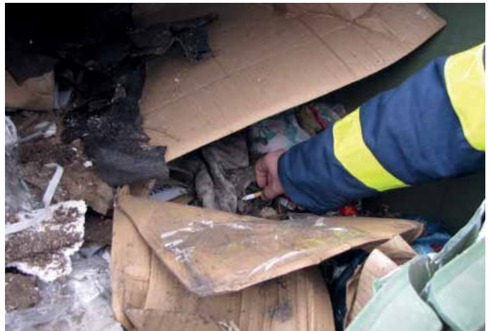
Pokus o zapálení odpadu uvnitř kontejneru žhavým nedopalkem cigarety. Po 10 minutách nedošlo ke vznícení žádného odpadu uvnitř kontejneru. Vzhledem k vlhkosti odpadu se tímto způsobem nepodařilo odpady zapálit.
