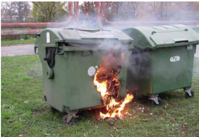
Pohled na hořící odpad v kontejneru, kdy došlo v důsledku tepla k degradaci plastového kontejneru. Levý kontejner byl zatím zcela nepoškozen.
