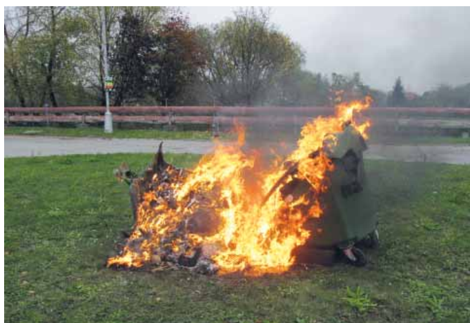
Třetí fáze požáru kdy hořely oba dva kontejnery. Teplota plamenů dosahovala max. výše až 700 °C.
