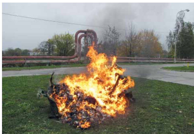
Postupné dohořívání odpadů i samotných plastových kontejnerů bylo doprovázeno vývinem tmavého kouře.
