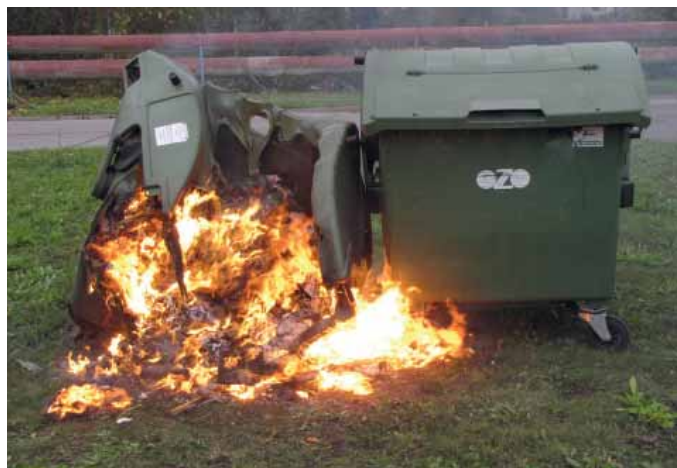
Po zborcení kontejneru dovnitř, docházelo k přenesení požáru na pravý kontejner. Teplota plamene dosahovala výše 600 °C.
