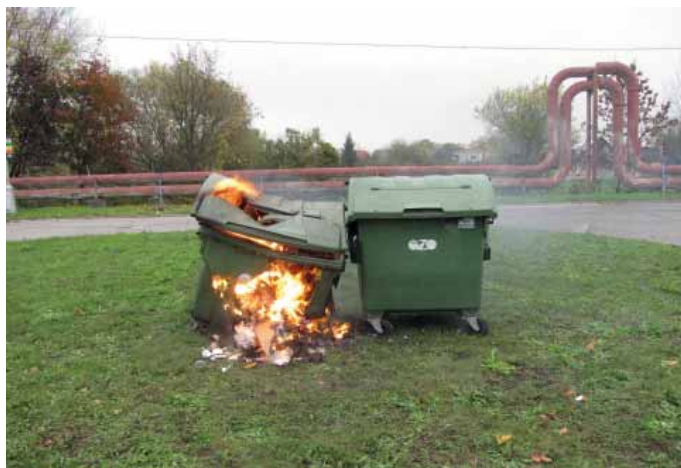
V této fázi pokusu došlo ke zborcení hořícího kontejneru a jeho „opření“ o pravý kontejner.
