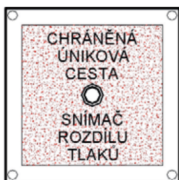
Obr. 10 Doporučené označení snímače rozdílu tlaků
