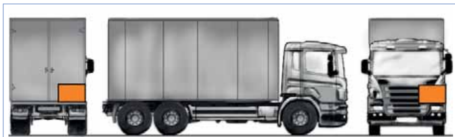
Obrázek 2: Označení dopravní jednotky je závislé na druhu dopravní jednotky a v některých případech na druhu převážené látky (na obrázku je vozidlo převážející nebezpečné věci v kusové podobě – kromě výbušnin a radioaktivních látek)
