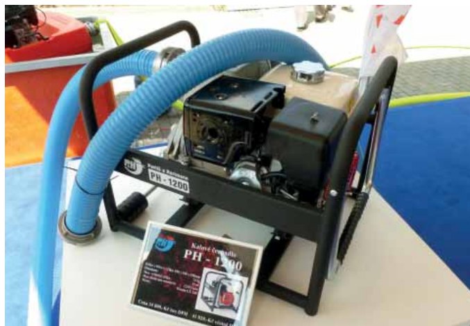
Kalové čerpadlo PH 1200s Pavliš a Hartmann s motorem Honda o hmotnosti 74 kg a výtlačnou výškou 25 m
