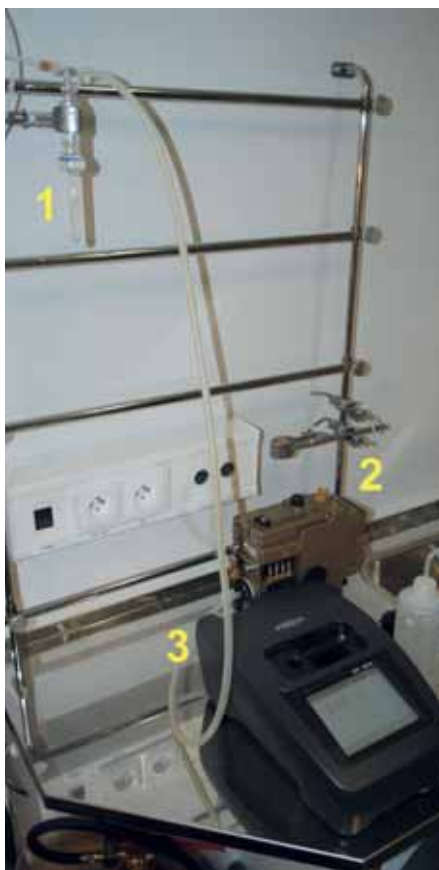
Aparatura pro odběr a analýzu P_2O_5 ze vzduchu (1 - minidebubler, 2 - čerpadlo, 3 - UV-VIS spektrometr pro analýzu)
